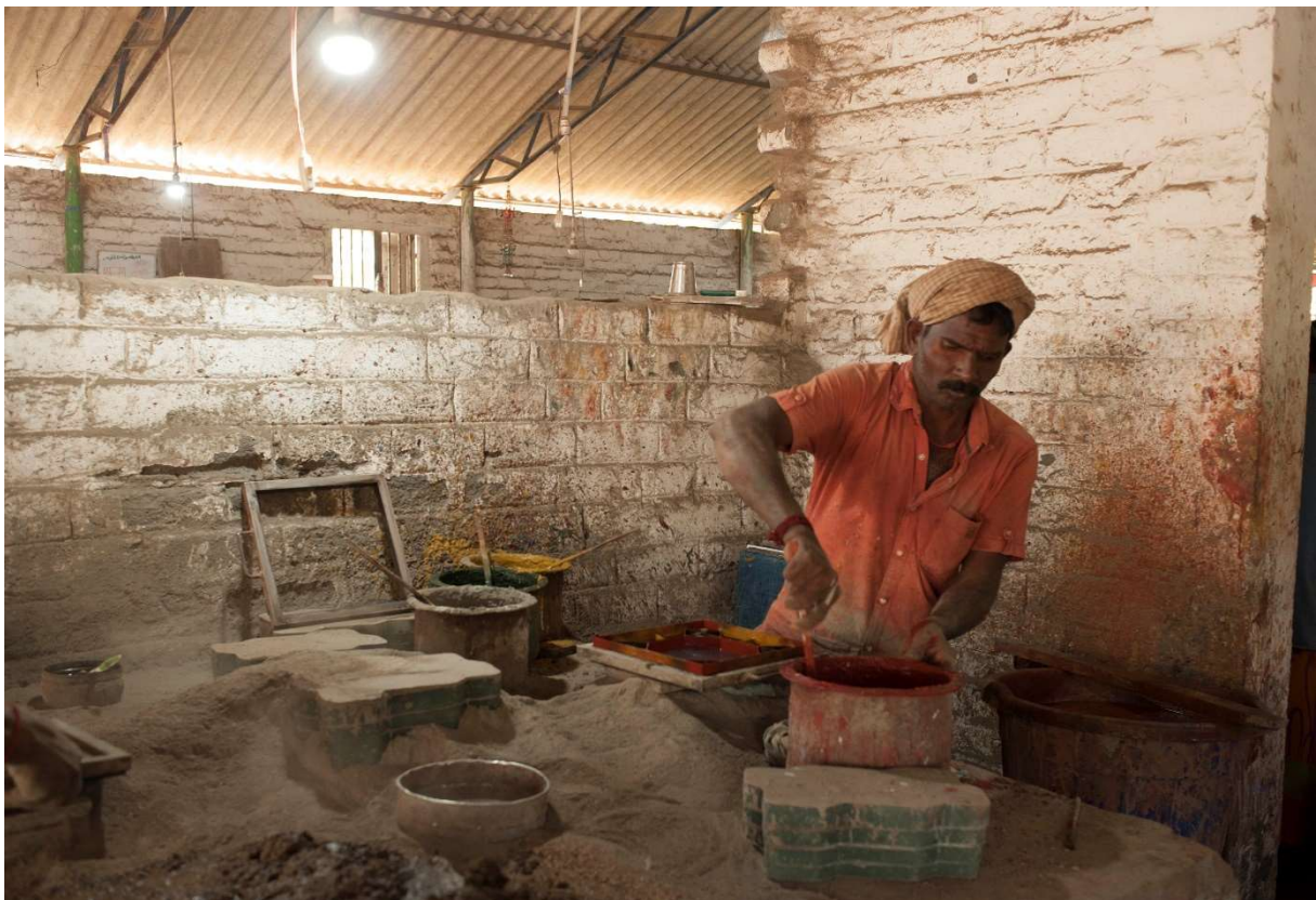
Un artisan à l'œuvre dans l'un des ateliers de carreaux de ciments décoratifs d'Athangudi. © Émilie Thièse
